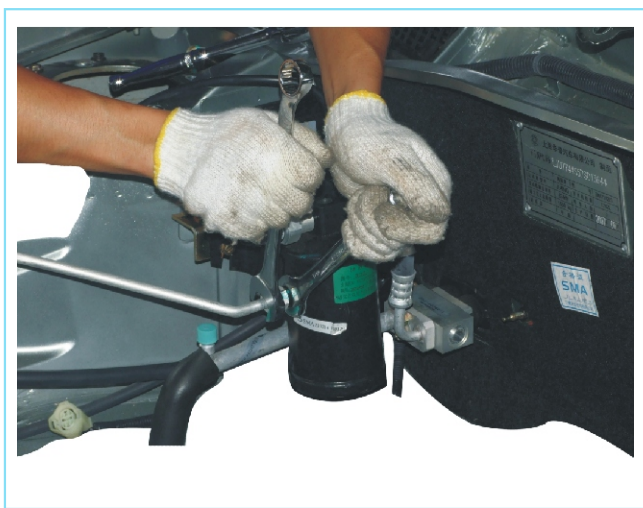
图8-14 用扳手拧紧空调管路
