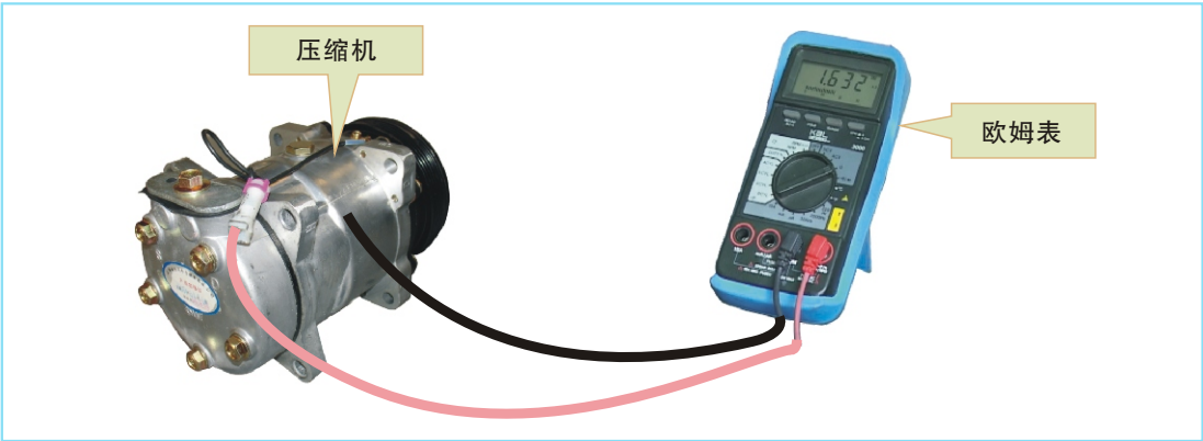
图8-22 测量定子线圈电阻
